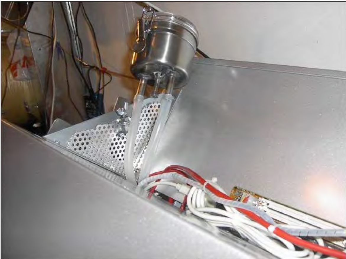
Das fertige Reservoir. Schlabbert aber noch rum, weil noch kein Deckel montiert ist.
